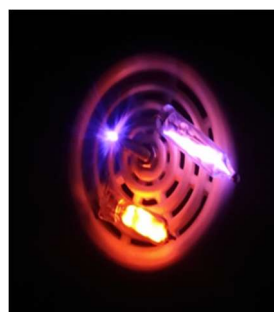
Рис. 6. Коронный разряд в темноте
