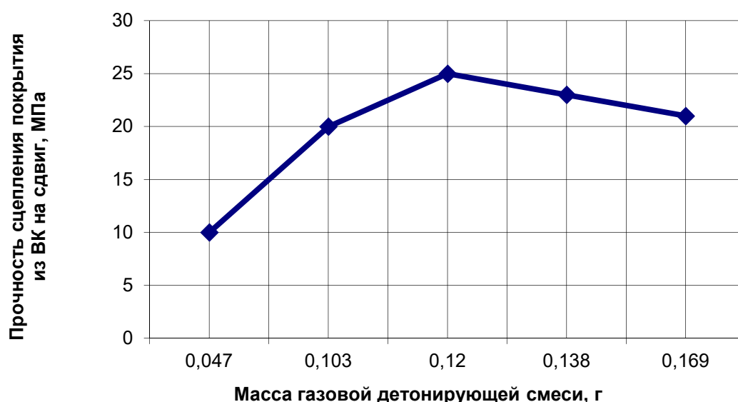
Рисунок 3 – Зависимость массы газовой смеси от прочности сцепления покрытия
