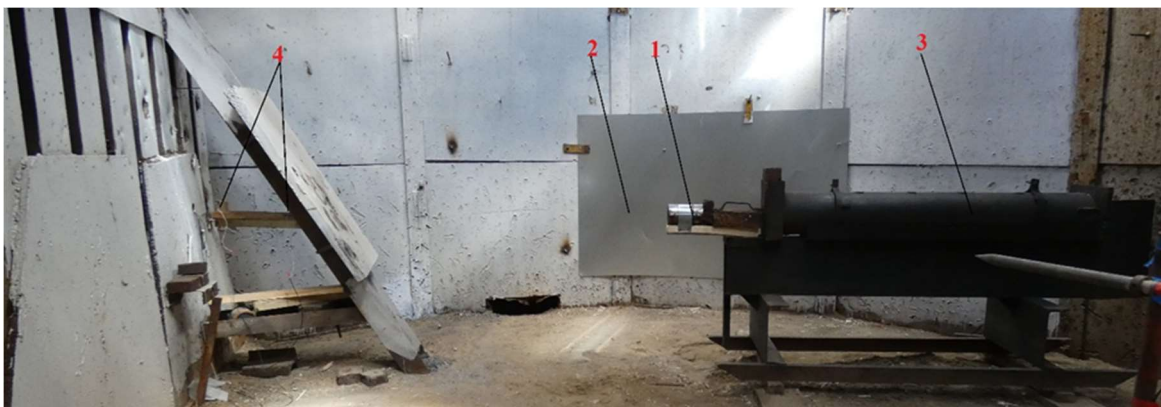
Рисунок 3 –Характерный внешний вид стенда перед испытанием: 1 – макет, 2 – пластина-свидетель, 3 – датчик ВУВ, 4 – рам-мишени.
